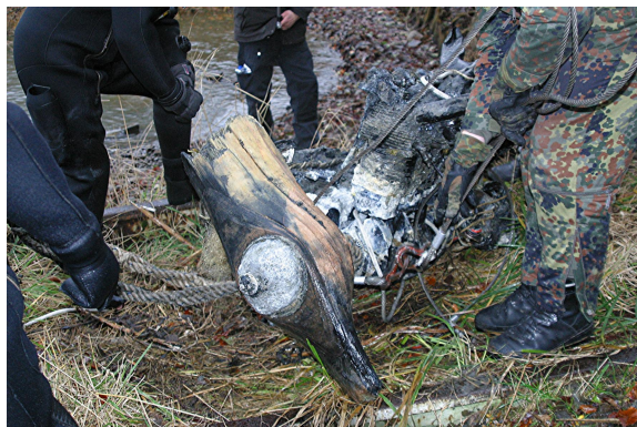
Bild 8 Bergung des Motorblocks (Argus AS 10C) mit abgescherten Luftschraubenblättern (Foto: Abraham)
