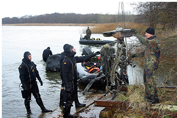
Bild 8 Bergung des Motorblocks (Argus AS 10C) mit abgescherten Luftschraubenblättern (Foto: Abraham)
